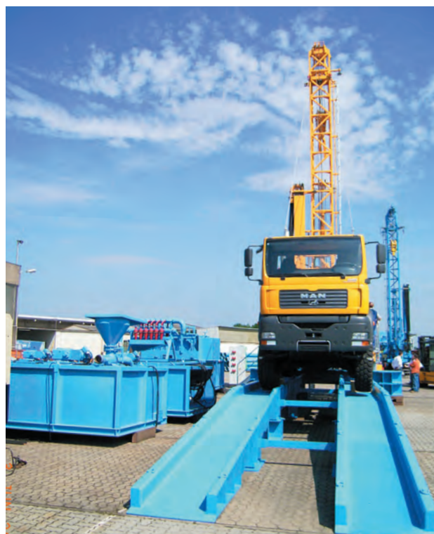
Prakla-Universalbohrgeräte mit Spülungstanksystem
