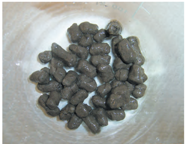
Cuttings nach 24 Std. in angesalzener Viscopolspülung
