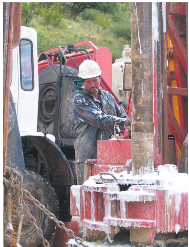
Schaumspülung für Im-Loch-Hammer Bohrungen im Festgestein
