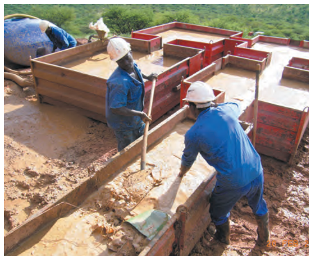
Spülungstanksystem für eine effektive Feststoffkontrolle
