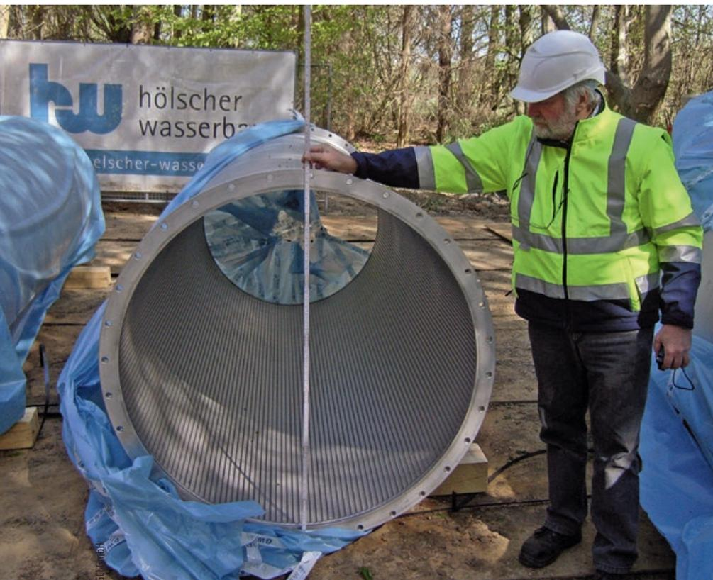
Abb. 3 – Wickeldrahtfilterrohr DN 1.200
