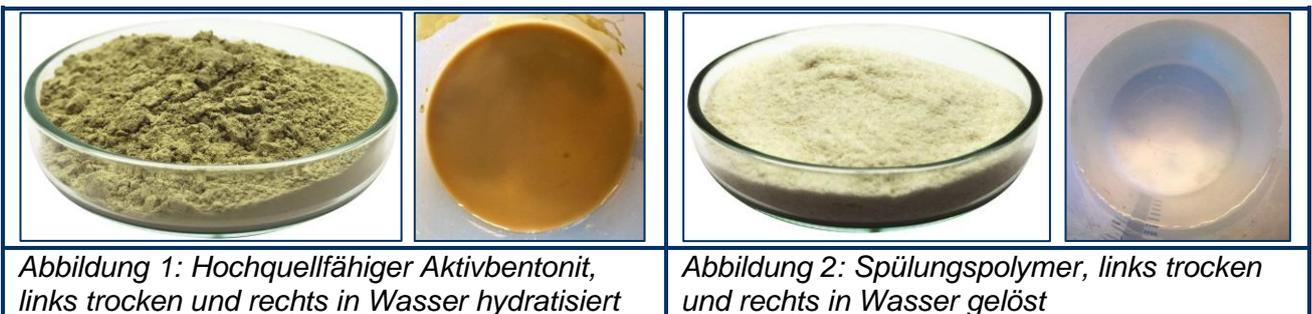
Des Weiteren reduzieren Polymere Spülungsverluste, da sie in Kombination mit feinen erbohrten Feststoffen oder Bentonit einen sehr undurchlässigen und dünnen Filterkuchen an der Bohrloch-
